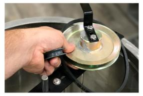
**STEP 4**NOW YOU CAN LIFT BOTH PULLEYS STRAIGHT UP AND OFF
